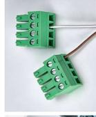
Фото 14. Подключение проводов датчика к ответной части разъема
