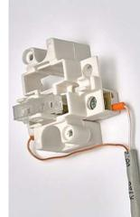
Фото 23. Подключение проводного выключателя. Фото 24. Подключение проводного выключателя
