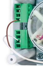
Фото 15. Подключение датчика к электроприводу
