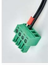
Фото 19. Подключение внешнего блока питания +12 В к ответной части разъема электропривода
